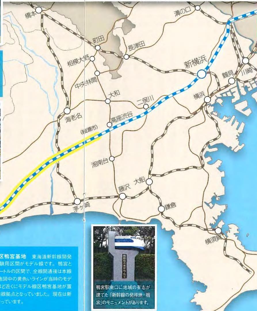
**モデル線とモデル線区鴨宮基地** 東海道新幹線開発のために建設された試験用区間がモデル線です。鴨宮と綾瀬を結ぶ約32キロメートルの区間で、全線開通後は本線に組み込まれました。地図中の黄色いラインが当時のモデル線です。鴨宮駅のほど近くにモデル線区鴨宮基地が置かれ、新幹線開発の前線拠点となっていました。現在は新幹線鴨宮保守基地となっています。
