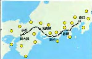
◀東海道新幹線では、開業1年後から地震を検知し列車を停止させる「制御用感震器」が設置され、現在ではさらに早期に地震の初動を捉え安全策を講ずる「テラス=TERRA-S（Tokaido shinkansen Earthquake Rapid Alarm System）」が稼働しています。●がテラス検地点（21カ所）
