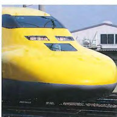
▲ドクターイエロー：新幹線電機軌道総合試験車。営業車並みのスピードで走行しながら、軌道・電気設備・信号設備を検査する業務車両。黄色い車体からドクターイエローの愛称で親しまれています。10日に1回程度の運行なので「目撃すると縁起がいい」などとも言われています。写真：JR東海
