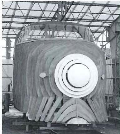
▲新幹線営業車0系以前のテスト車両である1000系の原寸大のモックアップ。曲面ガラスで、ライトが横に長いタイプです。写真提供：日本車輛製造
