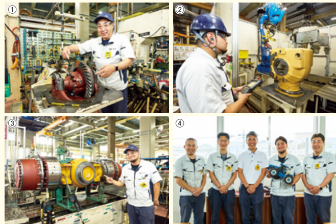
①2軸の交点で回転の方向を曲げて伝える「傘歯車」。②バリ取りロボットへのティーチング(詳細な作業指示)業務。③複数の歯車を格納するケース。④取材にご協力いただいた機器製造部(中央が久保部長)の皆さん。
