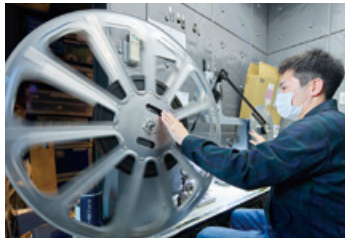
映画のフィルムは複数の缶に分けて映画館に届きます。映画館の映写技師がフィルム編集機（上記写真）で上映前につなぎ、上映後に元のように分割します。
